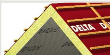
На коньке и хребте мансардных крыш диффузионные плёнки укладываются с перехлестом. Если в конструкции мансарды предусмотрено чердачное пространство, то оно должно быть проветриваемым через конёк: диффузионные плёнки следует уложить с вентиляционным зазором в районе конька и хребта. Рекомендуется дополнительное проветривание через фронтоны.
