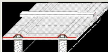
Наплавление рулонной гидроизоляции поверх сплошного настила и трапециевидной контрообрешётки
