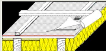
Укладка плёнки поверх сплошного настила, дополнительное уплотнение мест крепления гвоздями контрообрешётки
