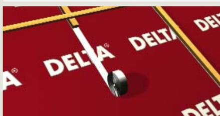
При устройстве гидроизоляции кровли с малым углом наклона помимо проклейки мест нахлеста пленок необходимо использовать уплотнительную ленту DELTA-NB-50 под контробрешетку для предотвращения затекания воды в конструкцию крыши через гвоздевое соединение. Проходки вентиляционных и канализационных вытяжек, антенных выводов через гидро- и пароизоляционные плёнки выполняются при помощи соединительных лент DELTA-FLEXX-BAND, DELTA-MULTI-BAND или специальных уплотнительных манжет.
