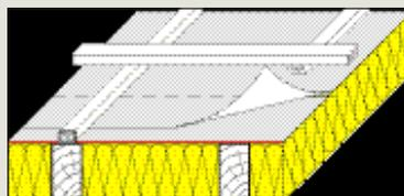
Укладка плёнки поверх стропильных ног непосредственно на утеплитель
