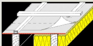
Укладка плёнки поверх стропильных ног над вентиляционным зазором
