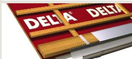
Пленки укладываются параллельно карнизному свесу с минимальным нахлестом 10 см. На все плёнки DELTA® нанесены маркировочные линии нахлёста. На карнизном свесе пленки укладываются на металлический капельник (карнизную планку) и приклеиваются к нему при помощи DELTA®-THAN или DELTA®-PREN.
