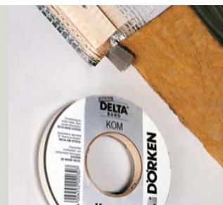
Предварительно сжатая, пропитанная акрилатом самоклеящаяся уплотнительная лента из полиуретана. Требуется применение прижимной планки.
