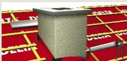
Примыкание плёнки к кирпичной или оштукатуренной стене, печной или вентиляционной трубе выполняется лентой DELTA®-FLEXX-BAND или клеем DELTA®-THAN. Использование ленты DELTA®-MULTI-BAND возможно только по гладкой поверхности (окрашенный металл, пластик, дерево). Соединение плёнок к не строганой древесине, имеющей шероховатую поверхность, можно выполнять только при помощи клеев: DELTA-THAN для гидроизоляционных плёнок и DELTA-TIXX для пароизоляционных плёнок.
